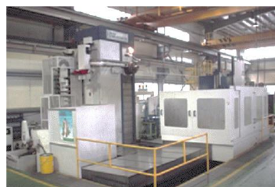
장비명 : HORIZONTAL BORING M/C 1호기 규격 : 3000×2000× Z1300
