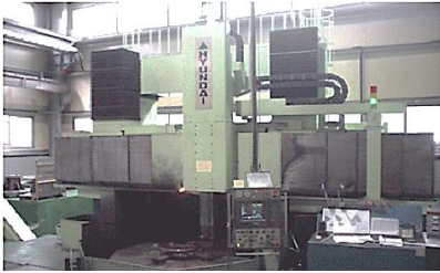
장비명 : VERTICAL TURNING M/C 규격 : max Dia. 3000 RAM1200×D2500
