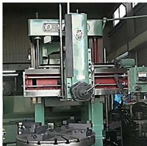
장비명 : VERTICAL TURNING M/C 규격 : max Dia. 1600 RAM800×D1200
