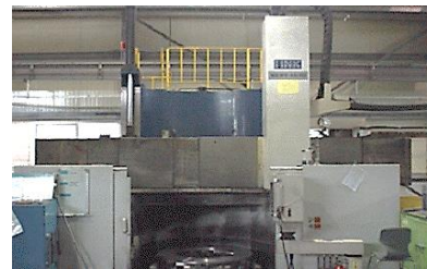
장비명 : VERTICAL TURNING M/C 규격 : max Dia. 2000 RAM900×D1600
