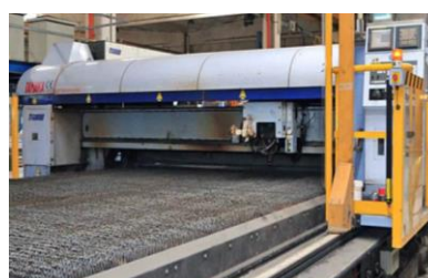
장비명 : LASER CUTTING M/C 작업가능규격: 3000×6000 최대절단두께: 20mm
