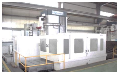
장비명 : HORIZONTAL BORING M/C 2호기 규격 : 3000×2000× Z1300
